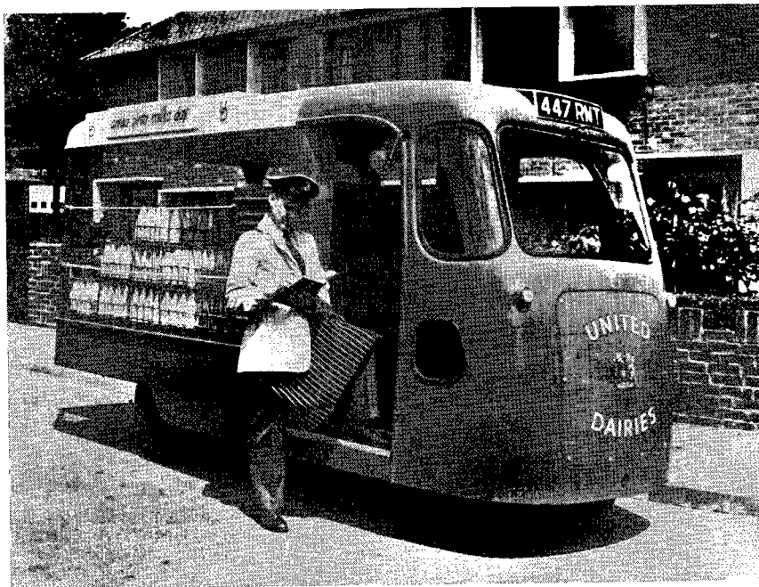
FIG. 4 CAMIONNETTE ÉLECTRIQUE MODERNE AVEC CARROSSERIE EN FIBRE DE VERRE
